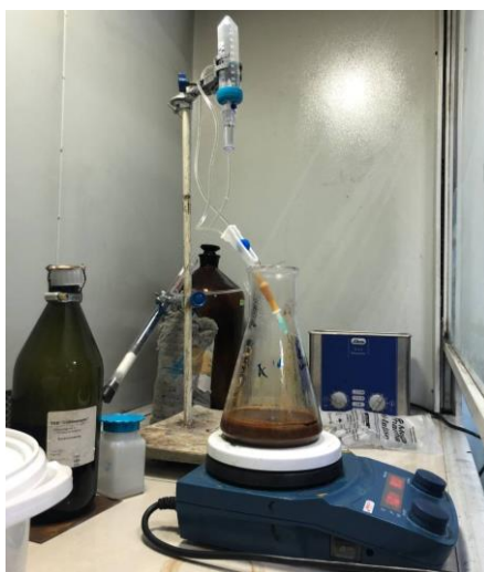
6 Сурет- 25% Сулы аммиак ерітіндісін ерітіндіге қосу
